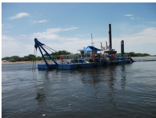
Figura 29. Draga de succión de 14"/12" a utilizar para el dragado.
