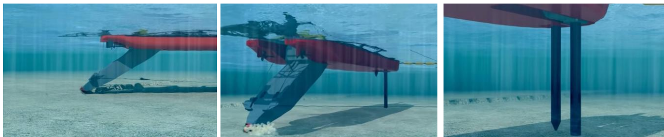
Figura 24. Operación de la draga de succión con cortador.
