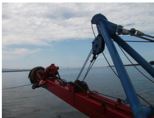
Figura 29. Draga de succión de 14"/12" a utilizar para el dragado.
